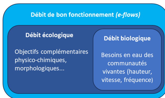
Figure 5 : Relation simplifiée entre les différents types de débits concourant au bon état des eaux
