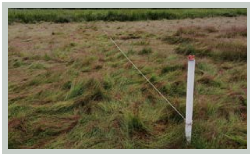
Transect et piézomètres combinés pour le suivi conjoint de la flore et des niveaux de la nappe © Vincent Colasse, CBNB
