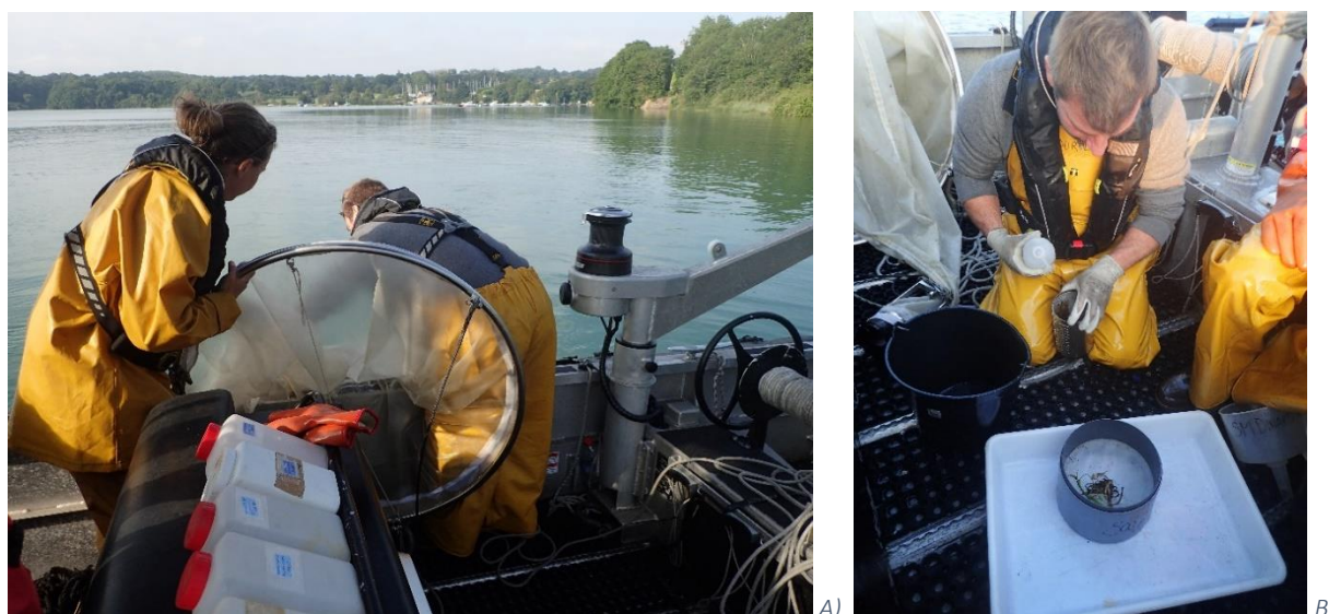
Figure 7 : Relève du filet ichtyoplanctonique (A) et vidange du collecteur dans le tamis de 500 µm (B)
